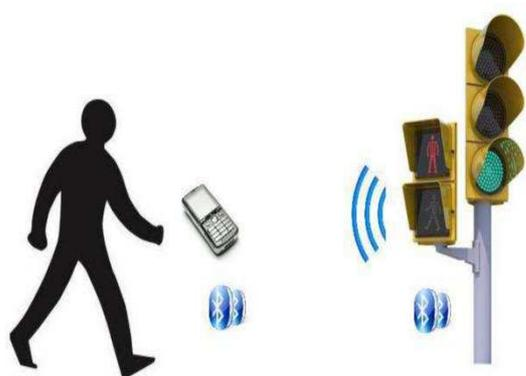
El sistema PASBLUE es un dispositivo diseñado para sonorizar los pasos de peatones semaforizados. A diferencia de otros sistemas, sólo se activa el sonido asociado a la luz verde del peatón a través de un pequeño mando a distancia o un dispositivo bluetooth. Por lo que en régimen normal, el sistema no emite ningún tipo de sonido.
